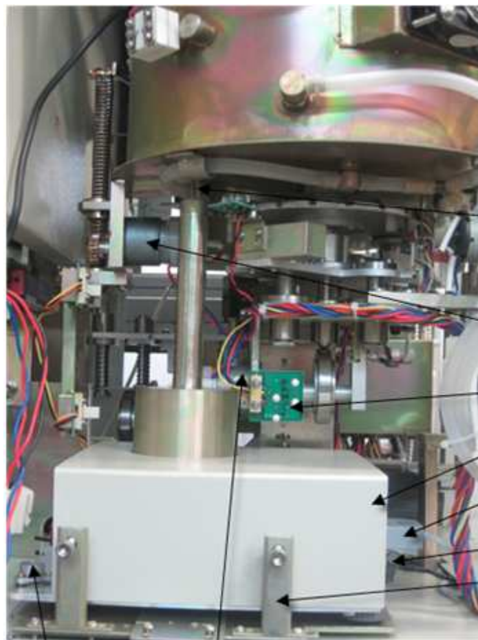
3.01.05.0070 DC motor 15r/min, 4.5kg.cm
