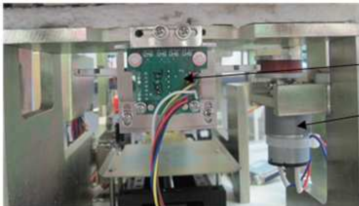
4.01.0081 Combustion carousel rotation locator card 3.01.05.0069 DC motor 10r/min, 3.5kg.cm
